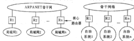
图 10.33 核心路由器的体系结构
