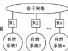
图 10.34 具有自治系统的互联网体系结构
