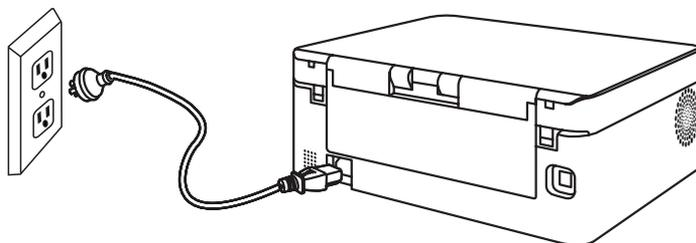
2 将电源线的另一端插入正确接地的交流电源插座内。
