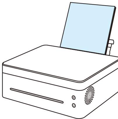
**3** 不要装入太多的纸。进纸托盘最大可装 50 张 (70g/m<sup>2</sup>) 纸。
