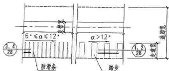
单皮带通廊平面布置图之一
