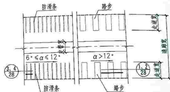
单皮带通廊平面布置图之二
