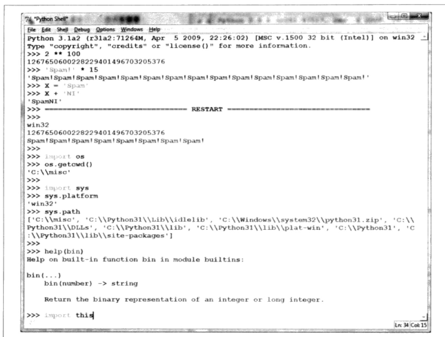
图3-3: IDLE开发GUI的主Python shell窗口, 在Windows下进行。使用File菜单开始一个(新窗口)或改变 (Open ...) 一个源文件; 使用文件编辑窗口的Run菜单去运行窗口的代码 (Run Module)
