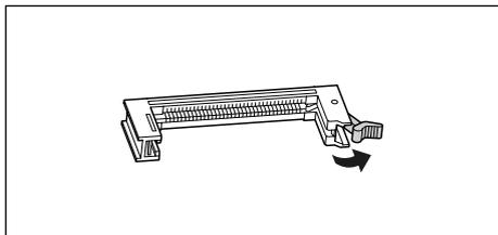
将 ROM 模块插入插槽时使其凹口 (A) 位于锁定杆 (B) 的相对一侧，然后将 ROM 模块完全按入插槽中。
