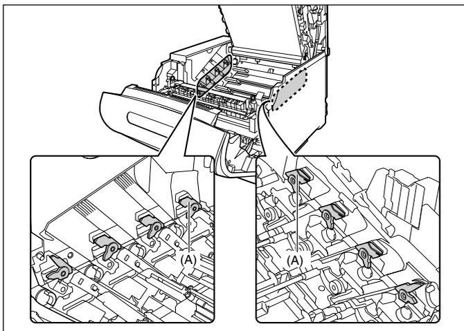
如果释放杆位置不正确, 则无法安装油墨滚筒。按图示抬起释放杆至正确的位置。
