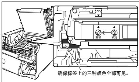
如果从正面看不见标签上三种颜色的任何一种颜色，请先将油墨滚筒取出，将卡舌(A)按照箭头方向旋转，直到发出“咔嗒”声并且不能再旋转，然后重新安装油墨滚筒。
