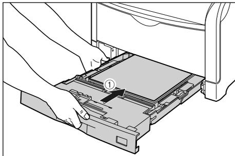
将纸盒的前端向上抬起一点后 ②，稳固地将纸盒推入打印机中，直到纸盒前端与打印机前表面齐平 ③。
