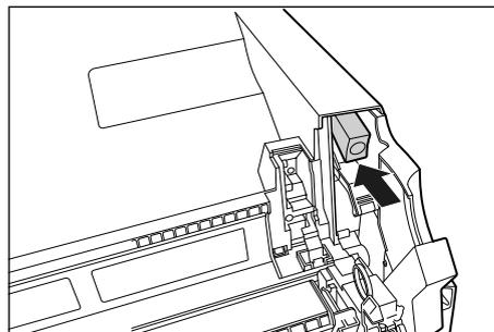
按住顶盖的释放杆，打开顶盖。
