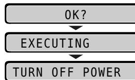
打印机在执行其操作后可以关闭时，出现信息 <TURN OFF POWER> (关闭电源)。
