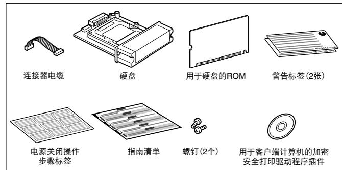
使用硬盘时，需要为硬盘安装硬盘随附的 ROM。安装 ROM 和硬盘。安装硬盘和 ROM 时需要使用飞利浦螺丝刀。请事先准备一把与螺钉尺寸匹配的螺丝刀。
