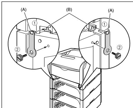
抬起打印机组件上的纸盒保护盖 ③, 将金属配件上的卡舌 (A) 插入打印机上的孔 (B)④, 然后用螺钉紧固 ⑤。
