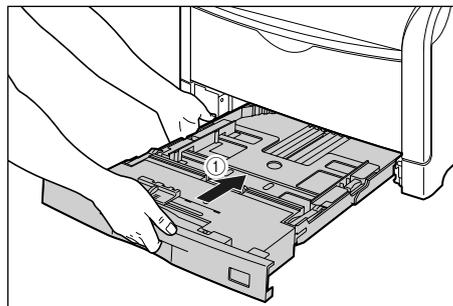
将纸盒的前端向上抬起一点后 ②，牢固地将纸盒推入打印机中，直到纸盒前面与打印机前表面齐平 ③。
