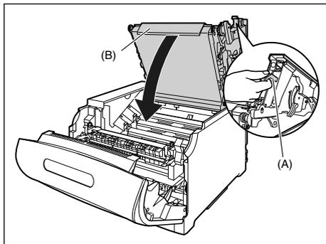
按下标有“PUSH”的部位，牢固地关闭顶盖直到无法再向下按，如图所示。
