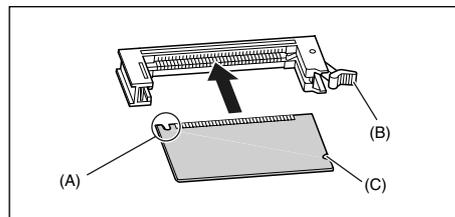
ROM 模块安装正确时，锁定杆上的卡舌卡在 ROM 的凹口 (C) 处。
