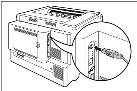
**3** 将 USB 电缆的 A 类 ( 扁平形 ) 端连接到计算机的 USB 端口。
