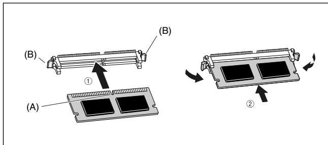
如果 RAM 模块安装正确，则 RAM 模块将被 RAM 插槽两侧的锁定杆 (B) 锁定。
