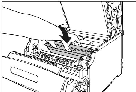
按图示将油墨滚筒每一侧的卡舌 (A) 插入油墨滚筒导板。
