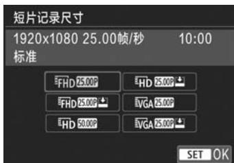
使用 [ 2: 短片记录尺寸 ]，可设置短片记录尺寸（图像大小、帧频和压缩方法）以及其他功能。
