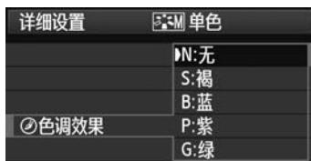
通过应用色调效果，可以在该颜色中创建单色图像。这样可以使图像更加生动。可以进行以下选择：[ N: 无 ] [ S: 褐 ] [ B: 蓝 ] [ P: 紫 ] [ G: 绿 ]。
