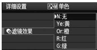
将滤镜效果应用于单色图像后，可以使白云和绿树更加突出。
