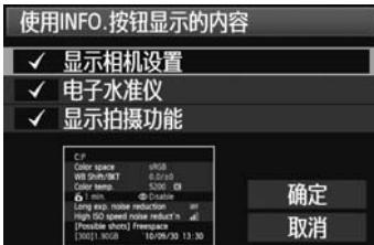
在相机处于拍摄状态下按下<INFO.>按钮时，可以显示 [ 显示相机设置 ]、[ 显示拍摄功能 ] ( 第267页 ) 和 [ 电子水准仪 ] ( 第127页 )。
