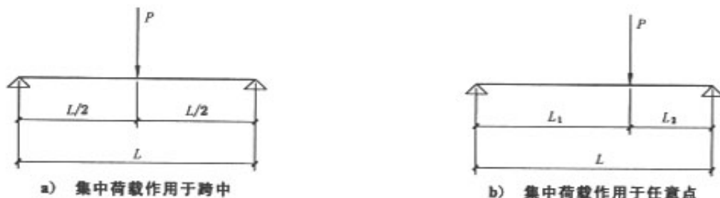
图 B.12 简支梁承受集中荷载示意图
