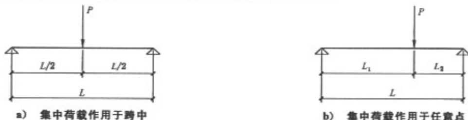
图 B.15 简支梁承受集中荷载示意图
