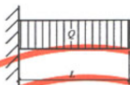
图 B.13 悬臂梁承受均布荷载示意图
