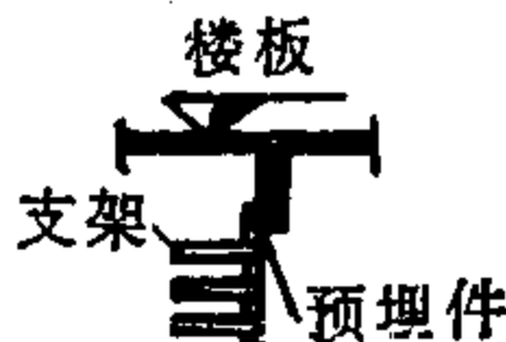
图 17-12 电缆吊架
