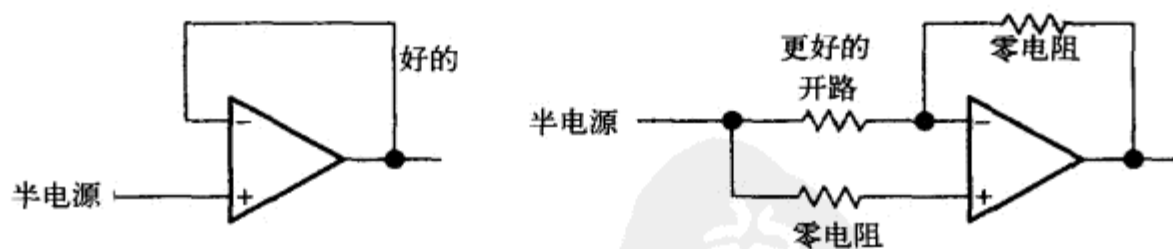
图 23-21 未用运放的正确端接
