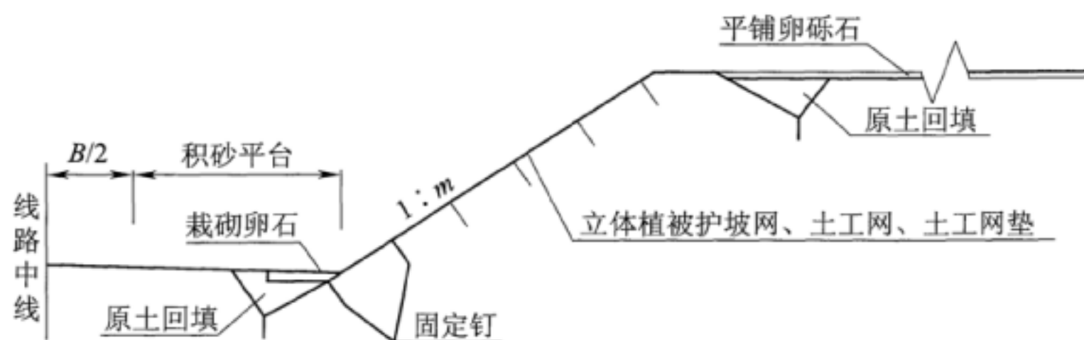
说明图 12.10.2—5 路堑坡面防护断面
