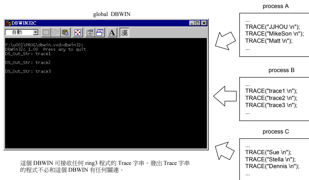
圖十 global DBWIN 的執行畫面。它是一個 Console 程式，在接受任何按鍵之前，將一直存在。
