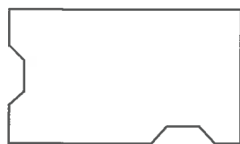
图 6.2.13 混凝土异形板桩截面图
