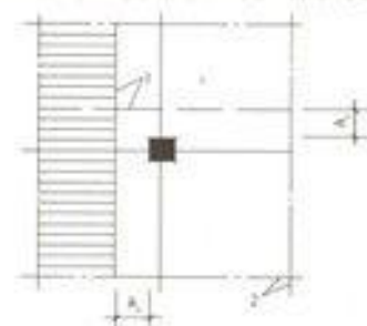
图5 内柱(筒)下筏板验算剪切部位示意图
