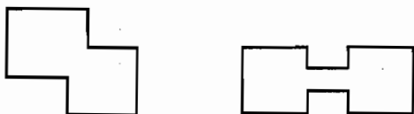
图1 角部重叠和细腰形平面示意
