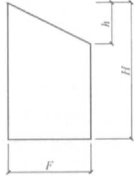
图 4.1.1 混凝土侧压力计算分布图形
