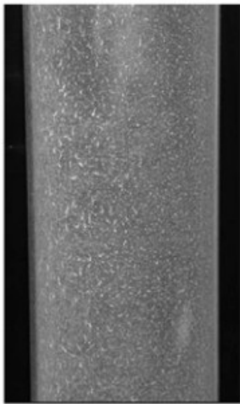
图 C.5 因 HF 引起的管子侵蚀
