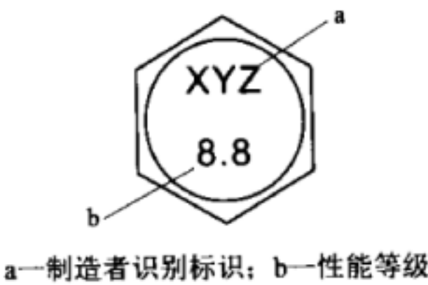
图 2 杆部带销孔六角头螺栓头部标志示例
