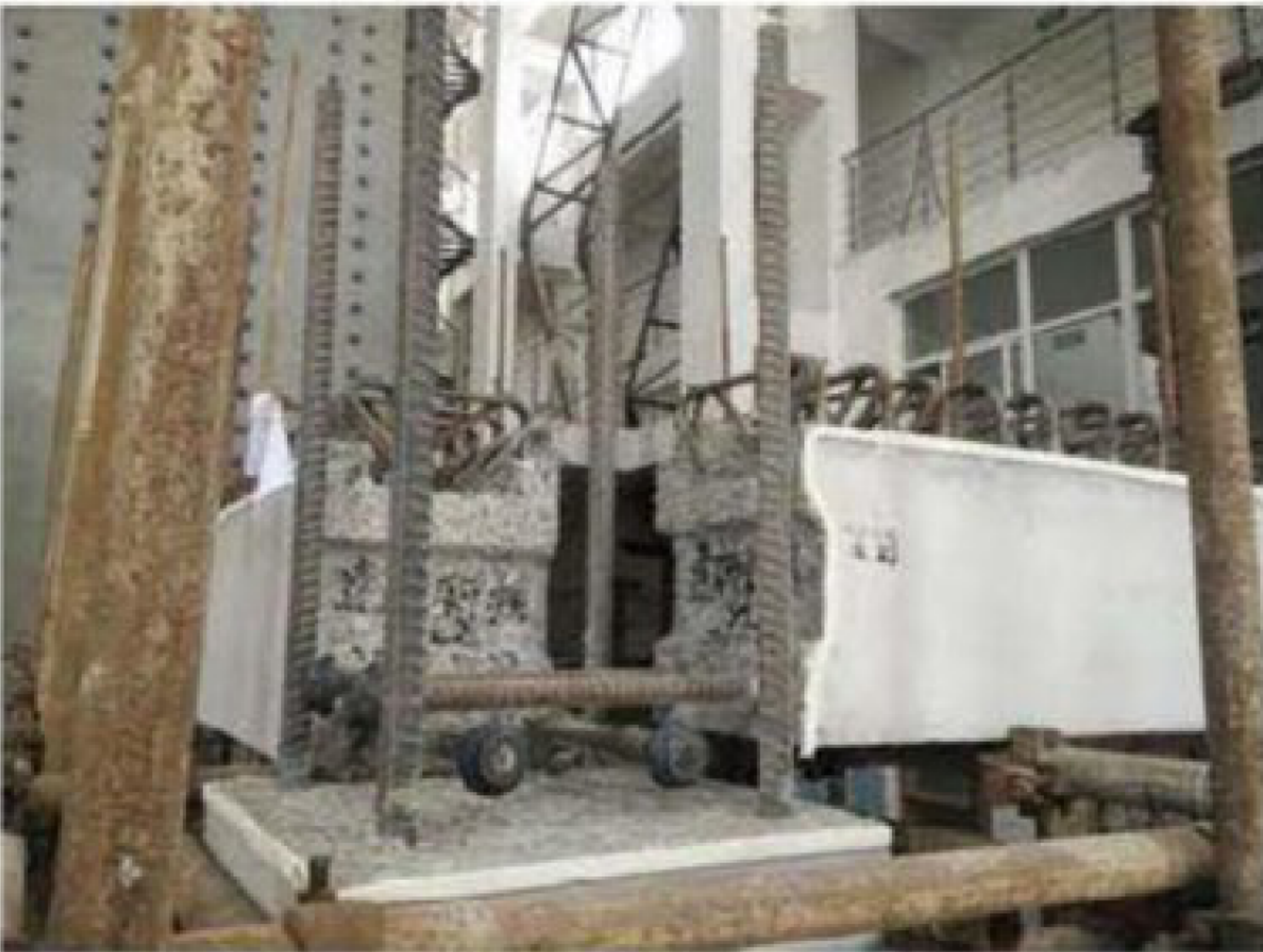
装配式混凝土结构-梁柱节点
