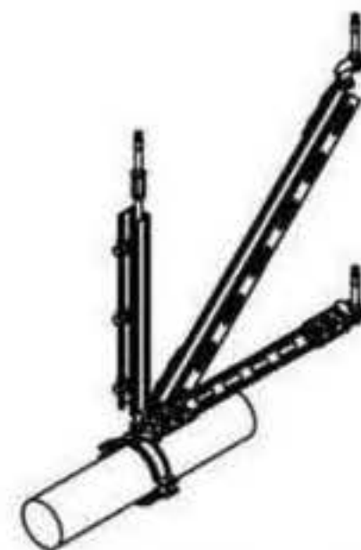
单根管道抗震支吊架
