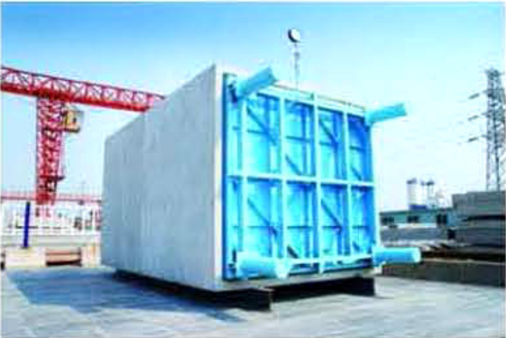
(c) 预制混凝土箱涵抗渗性能试验
