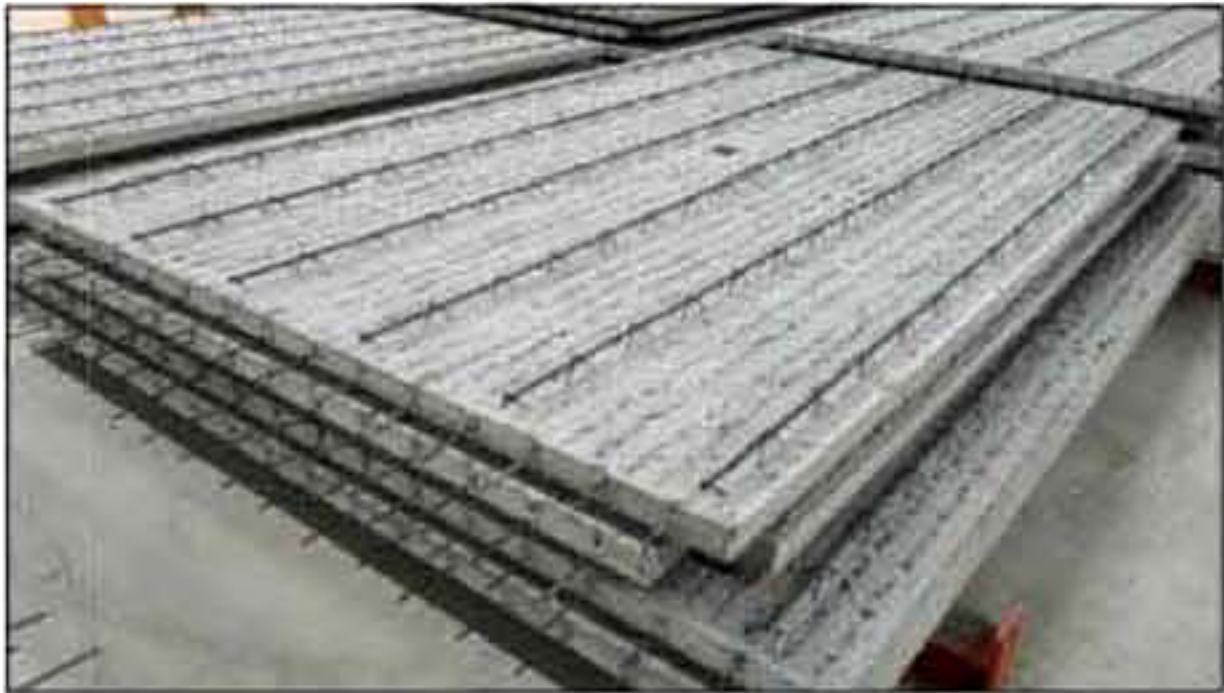
(e) 桁架钢筋混凝土叠合板底板
