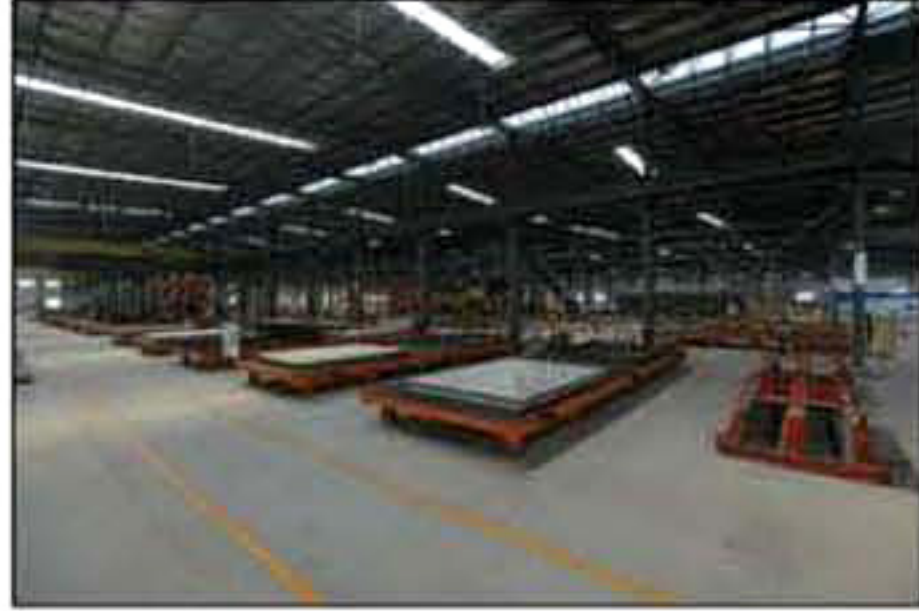
(a) 固定模台生产线1
