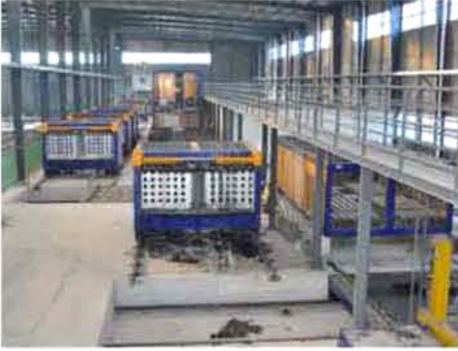
(b) 空心模成组立模生产线
