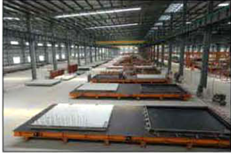
(b) 固定模台生产线2
