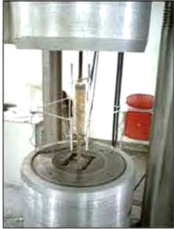
(b) 灌浆套筒拉拔试验
