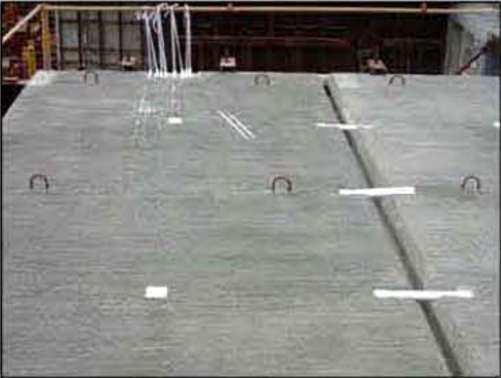
(e) 预埋线管预制叠合板底板
