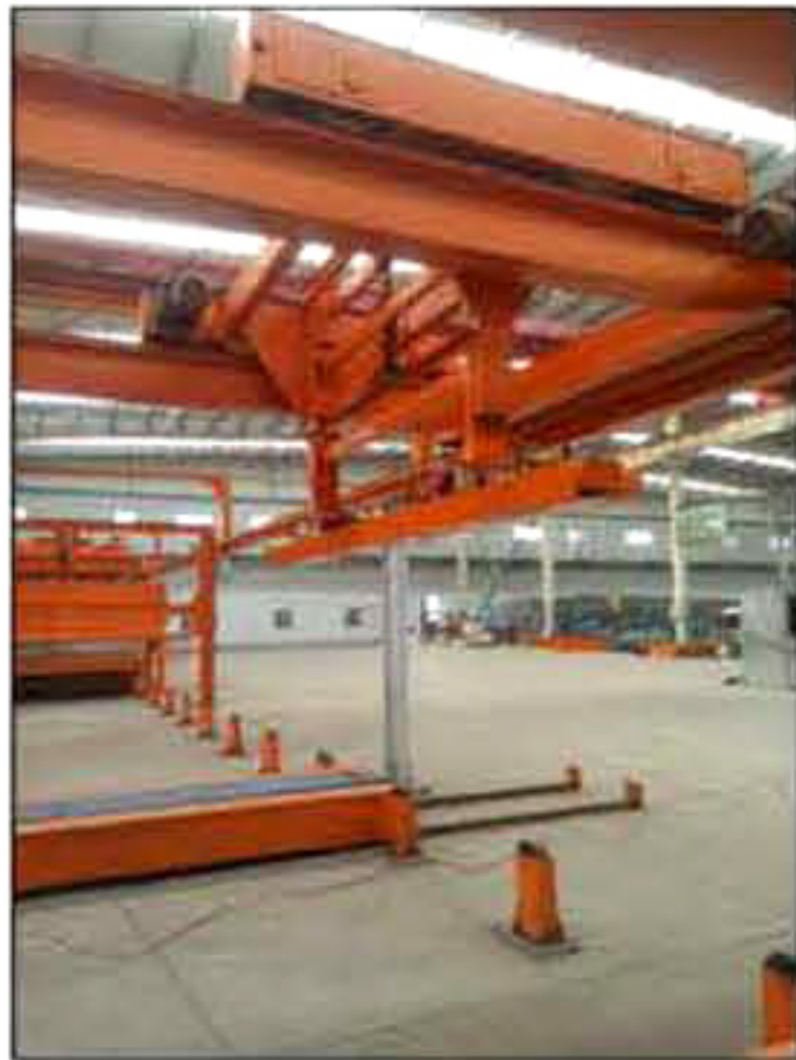
图H. 8 振动赶平机
