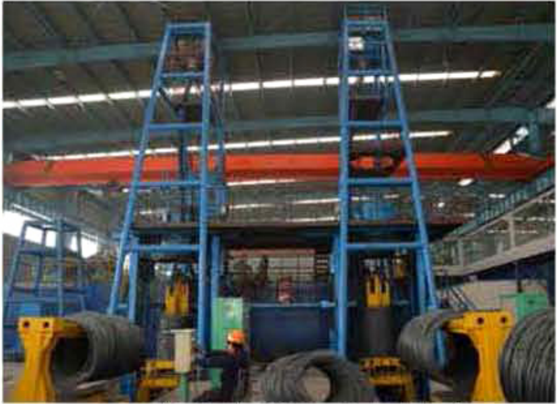
(b) 连续高速叠放立式上料装置
