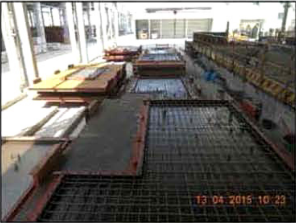
(a) 预制叠合板底板生产现场
