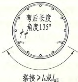
图1.17-3 圆形箍筋
