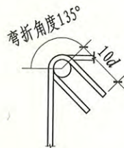
图4.12-4 受扭梁箍筋弯钩
