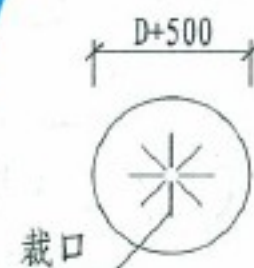
雨水口附加防水层叉面裁剪图
