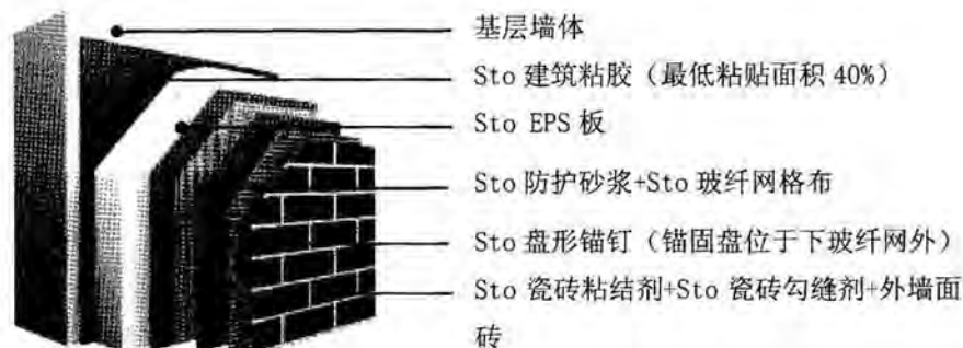
“Sto 面砖饰面”外墙外保温系统构造
