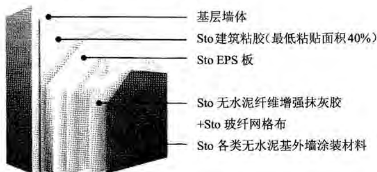
“Sto 经典”外墙外保温系统构造
