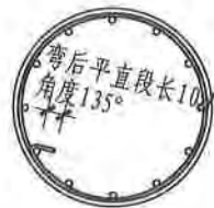
图4-2 螺旋箍筋端部构造
