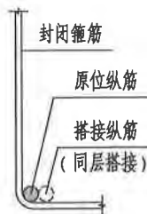
图11 封闭箍筋转角位置 (转角处无弯钩)
