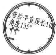
图4-2 螺旋箍筋端部构造
