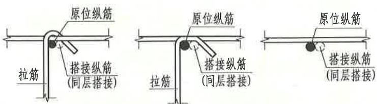
图5-3 剪力墙分布钢筋处的钢筋搭接位置
