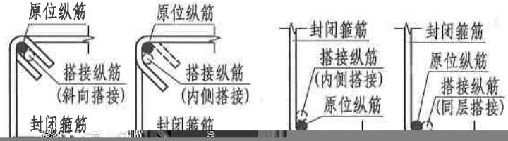
(a) 转角处有弯钩 (b) 转角处无弯钩
