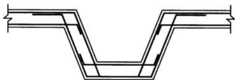
积水井配筋示意图
