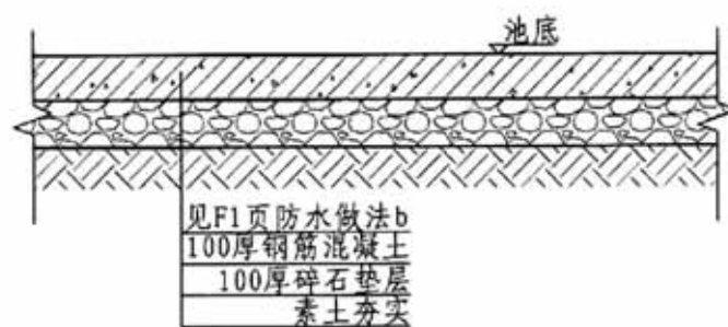
④ 池底大样四 (钢筋混凝土)
