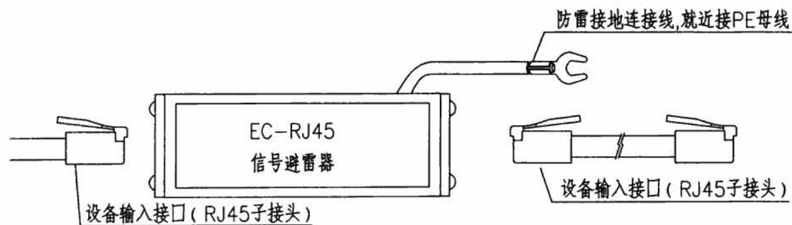
ECRJ45 HYR45S2-8 信号避雷器安装示意图
