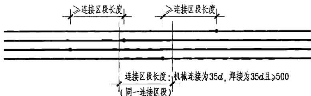
同一连接区段内纵向受拉钢筋机械连接、焊接接头
