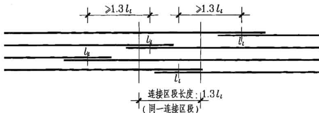
同一连接区段内纵向受拉钢筋绑扎搭接接头
