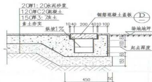
⑤ 暗沟(带预制钢筋混凝土盖板)
