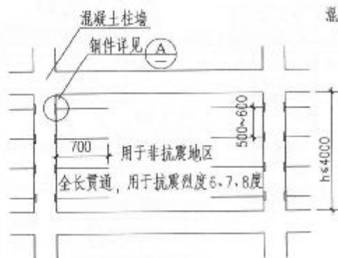
① 砌块墙体拉结筋示意
