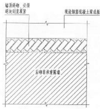
③ 非抗震设计, 抗震设计时非承重隔墙墙长<5m
