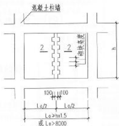
③ 砌块墙体构造柱示意
