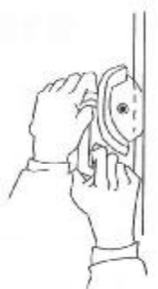
电动切割机开槽
