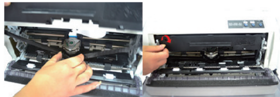
4.捏住色带导带器将两边卡爪沿字车斜插到打印头两边固定孔中，色带必须卡到打印头和色带导片之间！转动旋钮使其不能卷曲褶皱；
