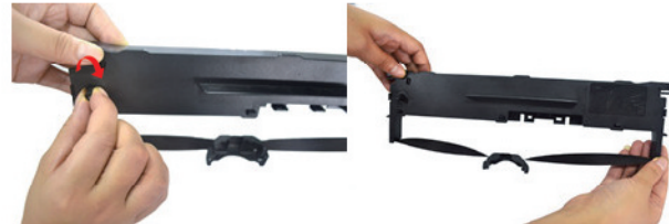
3.取出色带向前拉动色带导带器，按箭头方向转动旋钮拉直色带并旋转数圈，测试色带；
