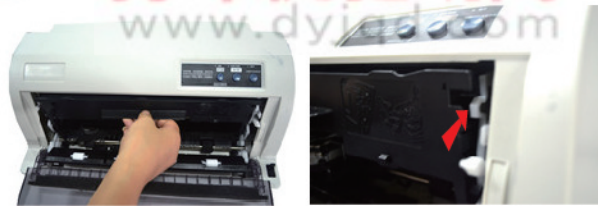
5.手拿色带盒把手，水平推入机器中，使卡槽卡入机器中；
