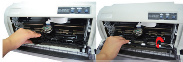
2.向自己方向水平拉动搓纸板，向外旋转使其成打开状态；
