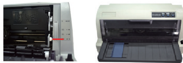
6.将档位调节杆拨到“D”位置，关闭压纸杆和透明盖，装上导纸托板。
