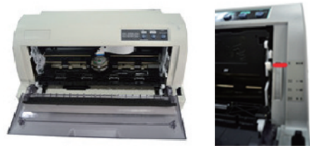
1.关闭打印机打开透明盖；将档位调节杆拨到“N”的位置；
