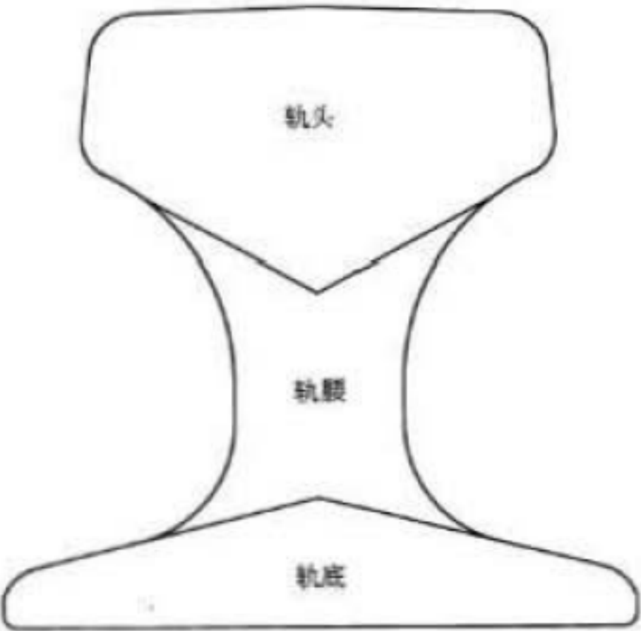
图 C.1 钢轨横断面分区定义
