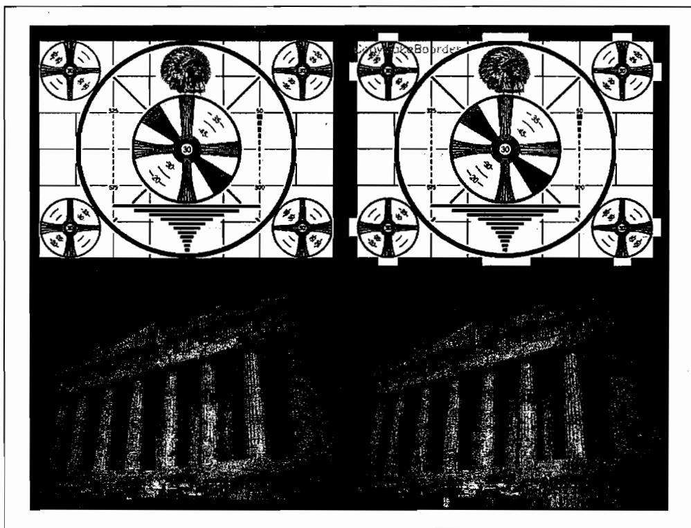
图 6-2：扩大的图像边界，左列显示的是 IPL_BORDER_CONSTANT ，边界是用 0 值填充的，右列是 IPL_BORDER_REPLICATE ，在水平和垂直两个方向复制边界像素
