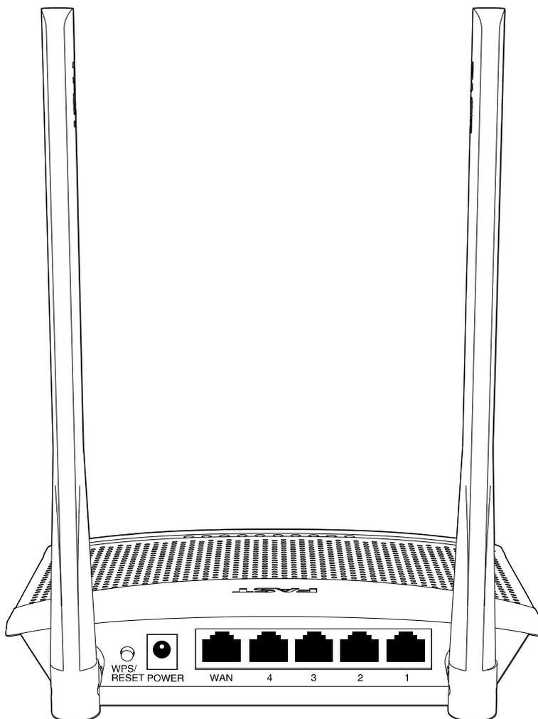
图2-2 FW300R 后面板示意图
