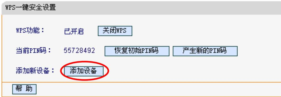
4. 在随后出现的界面中选择**输入准备添加的新设备的PIN码**，在下方的PIN码框中输入在第2步记录的8位网卡PIN码，然后单击**连接**按钮。
