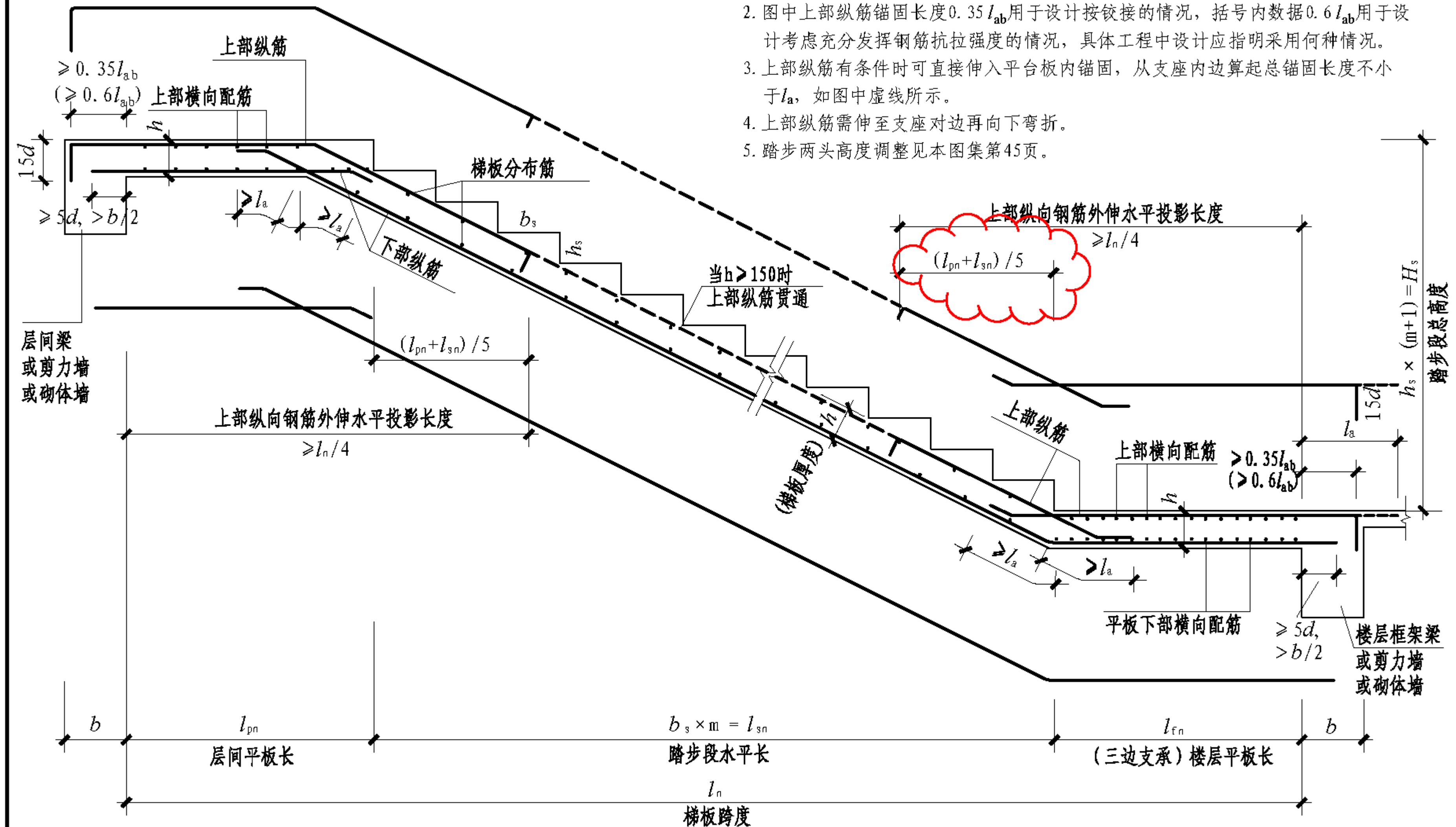
GT楼梯板配筋构造 (A—A) (楼层平板为三边支承，层间平板为单边支承)
