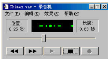
图15-1 可以使用Windows的录音机和一个接在声卡上的话筒来录制Wave文件,从而用做背景音乐
