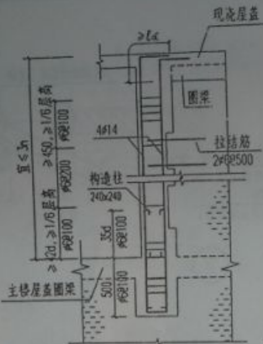
② 主楼顶层无构造柱
