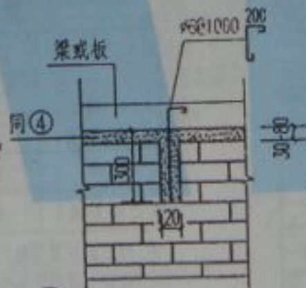
⑤ 填充墙与梁板的连接(3) (用于墙长大于5m或墙高超过4m)
