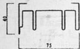
推拉窗外框(上滑) TBC8002A—1.484kg/m
