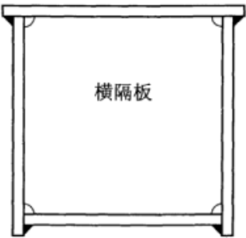
说明图 6.2.6—2 箱形杆件 截面隅角处的角焊缝
