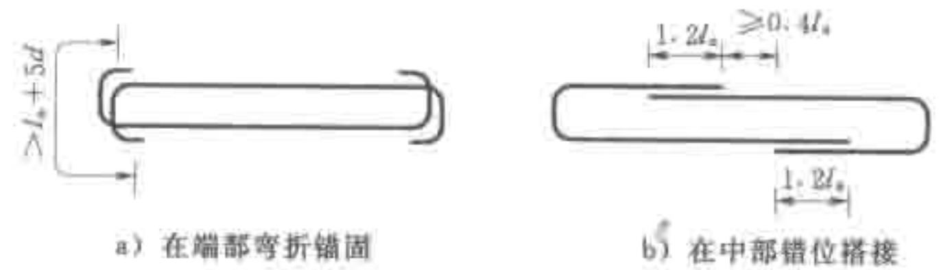
图 10.6.17 分布钢筋的搭接
