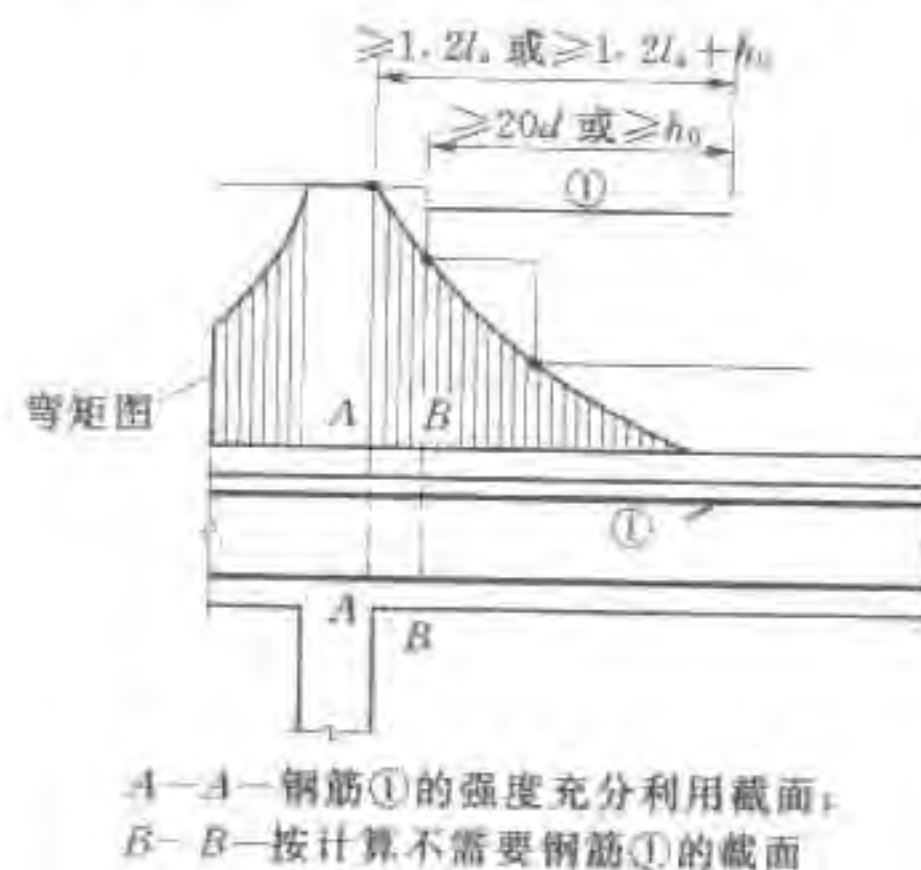
图 10.2.4 纵向受拉钢筋截断时的延伸长度
