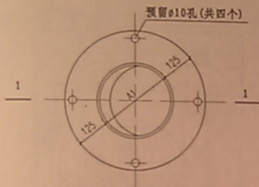
① 无动力风帽底座接口钢板
