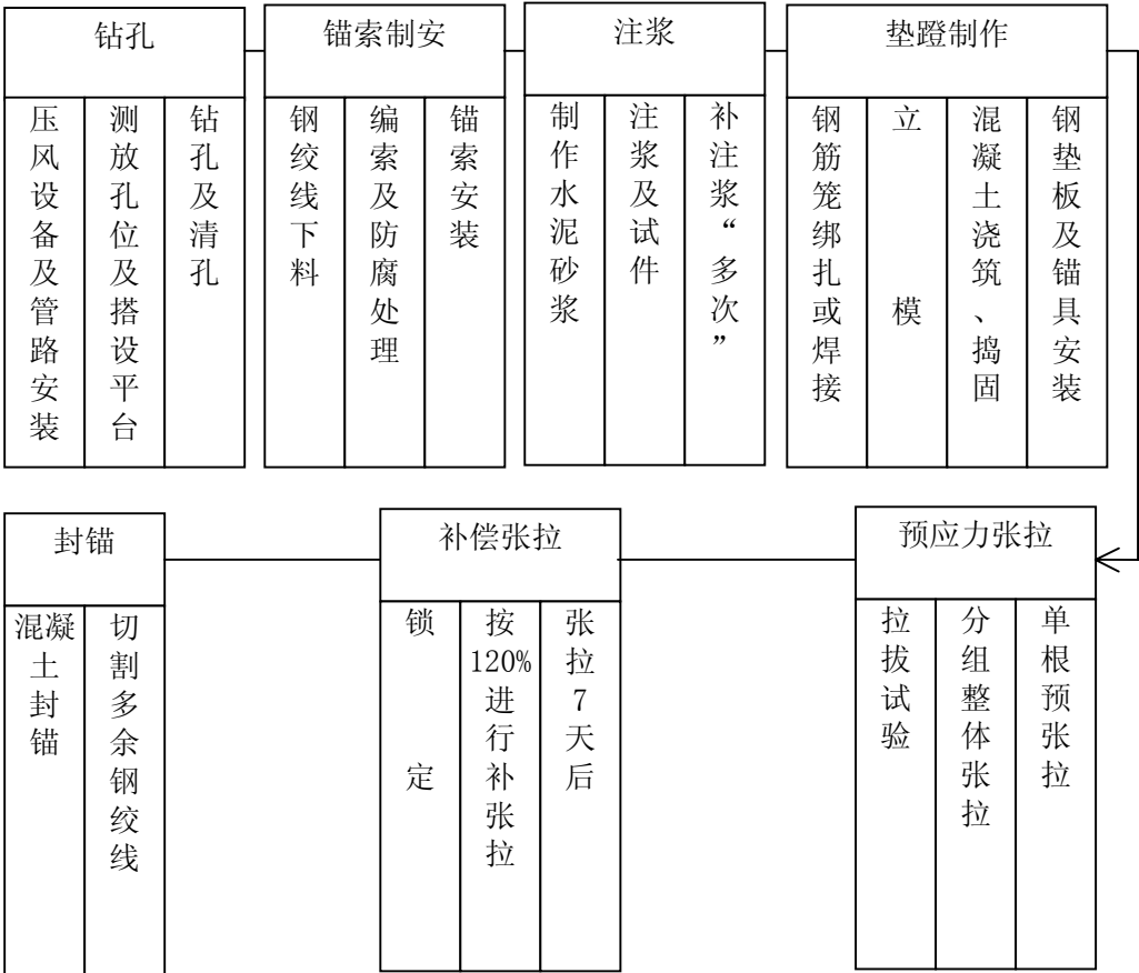
图 2-1-5-3 锚索施工工艺流程图
