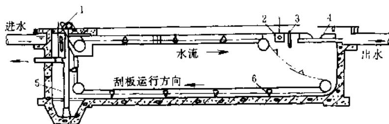
图 2.4.17 链条式刮泥机平流初次沉淀池
