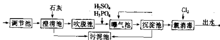
图 4.8.2 物化—生化复合处理系统
