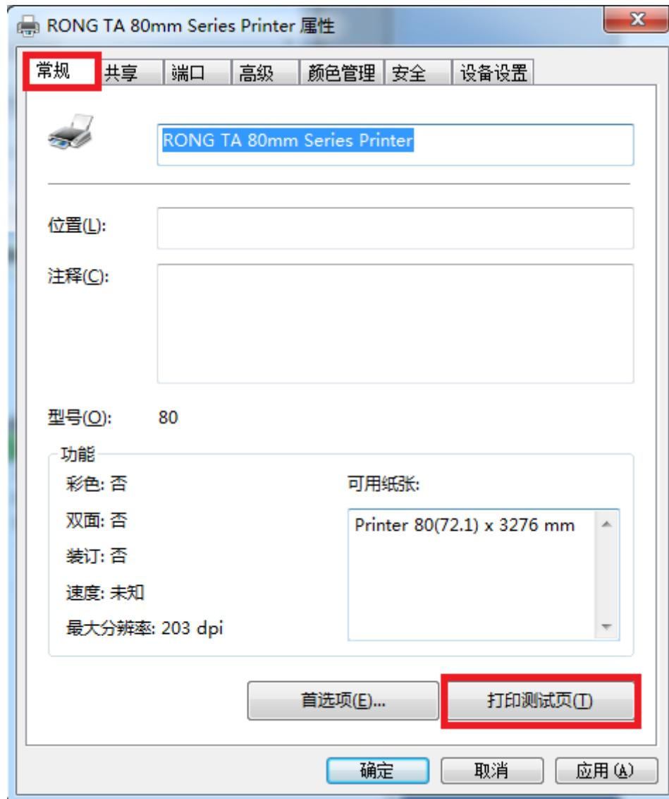
然后选择“打印测试页 (T)”，如能正常打印则说明打印机与 PC 端连接及配置正确，可以正常使用打印机该端口。
