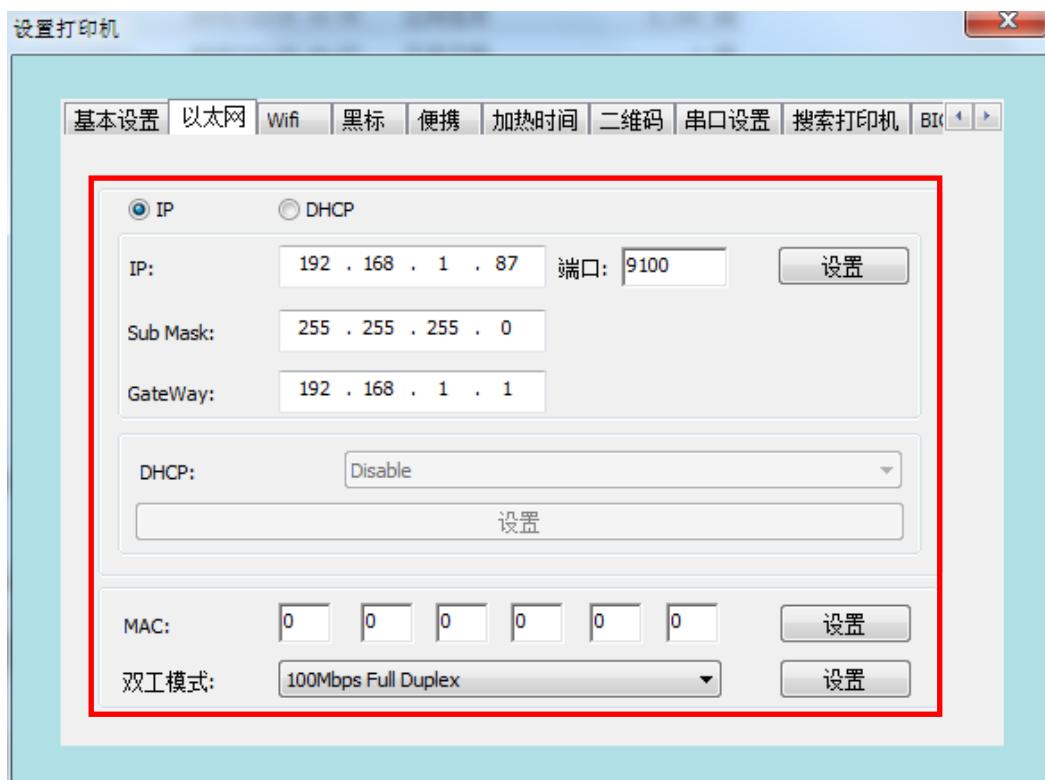
注意：在设置网址之前，如果连接打印机的方式为以下两种方式：“一”使用“网口端口”，“二”打印驱动方式中的IP地址，在经过更改IP之后，打印机的IP地址已经更改。此时，打印机与工具连接已经断开，需要重新设置工具的IP地址，才能连接打印机。而其他连接方式没有影响。
