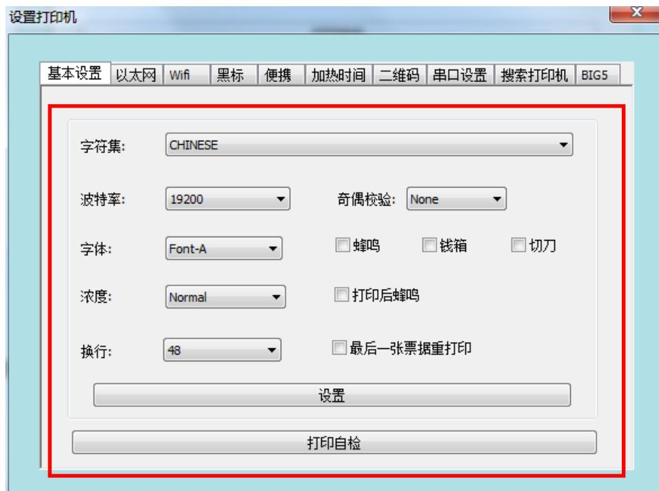
注：如果用户使用的是串口进行打印，则在波特率更改后，用户需返回到主界面对串口的波特率进行重新配置后，方可重新使用设置工具。
