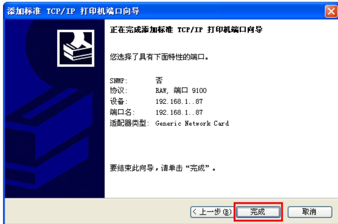
然后选择“完成”，即标准 TCP/IP 打印机端口添加完成。
