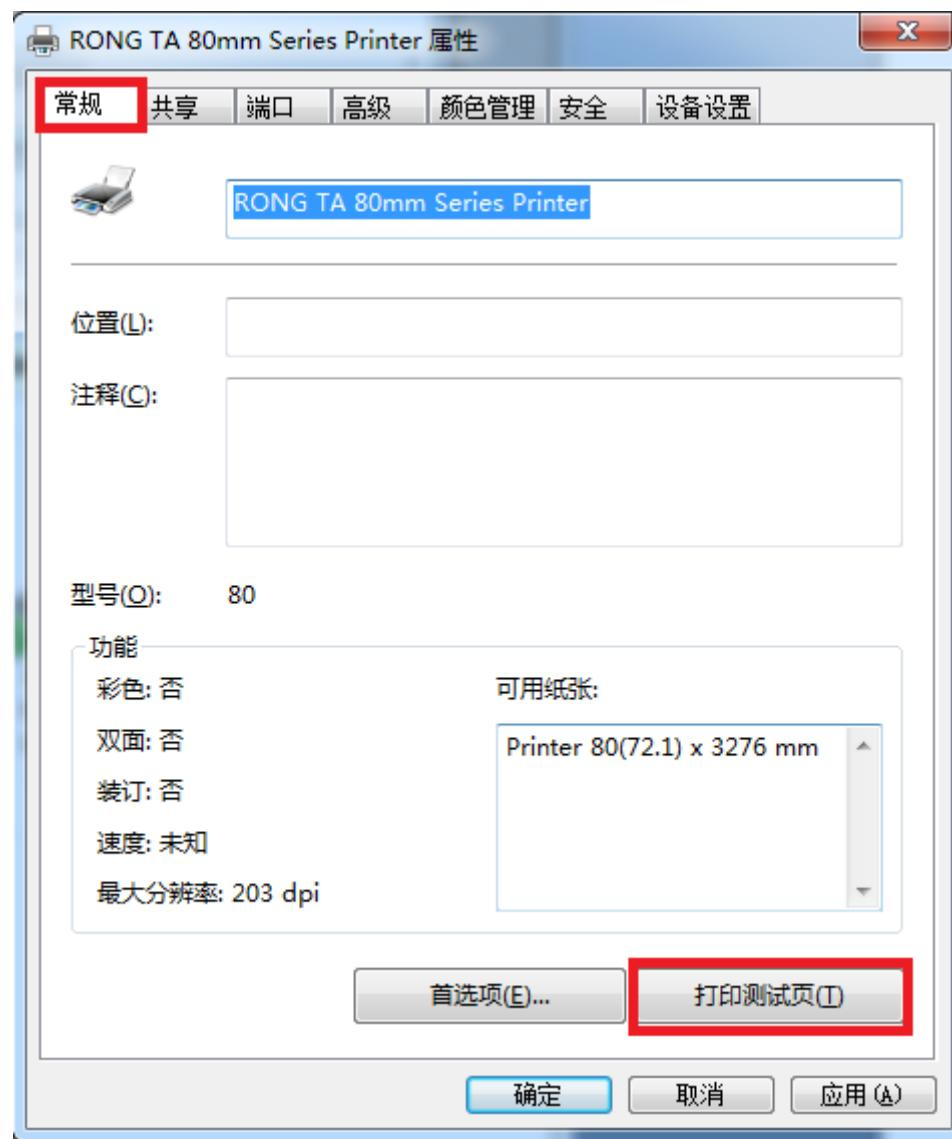
然后选择“打印测试页 (T)”，如果能正常打印测试页则打印机与 PC 端连接及配置正确，可以正常使用打印机该端口。
