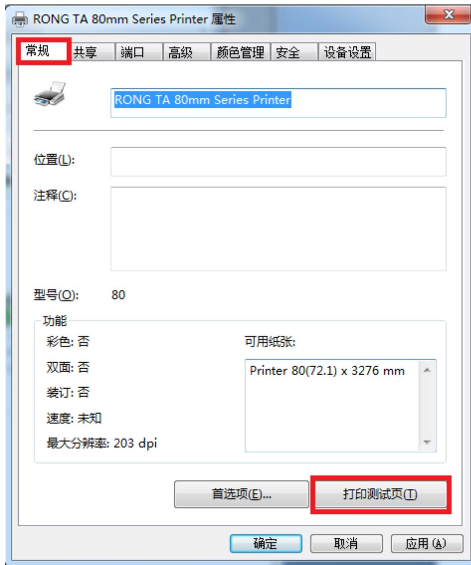
选择“打印测试页 (T)”，如果能正常打印测试页则打印机与 PC 端连接及配置正确，可以正常使用打印机该端口。
