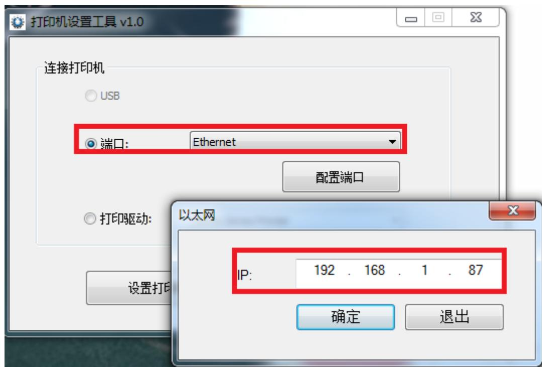
b. 选择“查找打印机”，查找成功后，会显示打印机相应的 MAC 地址、IP 地址等，选择打印机，然后执行相关的配置或操作
