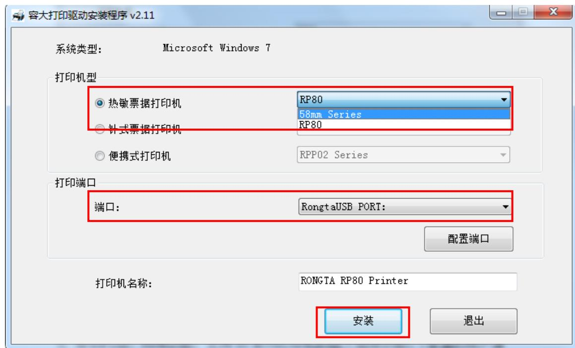
选择相对应的打印机型号和端口，然后点击“安装”如下图所示：
