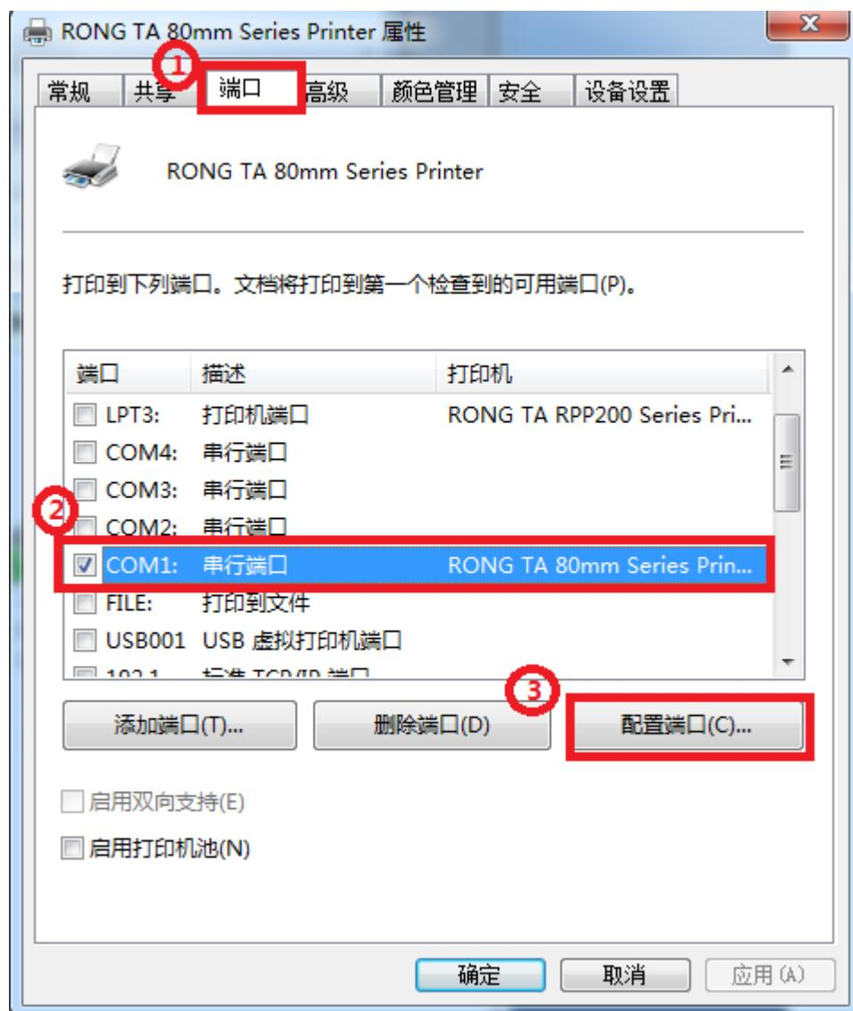
选择相对应的串行端口（以 COM1 为例），选择 COM1，然后选择配置端口，出现如下对话框：设置每秒位数的数值同打印机波特率一致，如打印机波特率为 19200，则选择打印的串口属性中每秒位数需设置为 19200。
