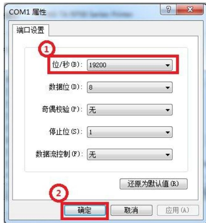
设置完成，点击“确定”保存设置。回到打印机属性窗口，选择“应用 (A)”，如下图所示
