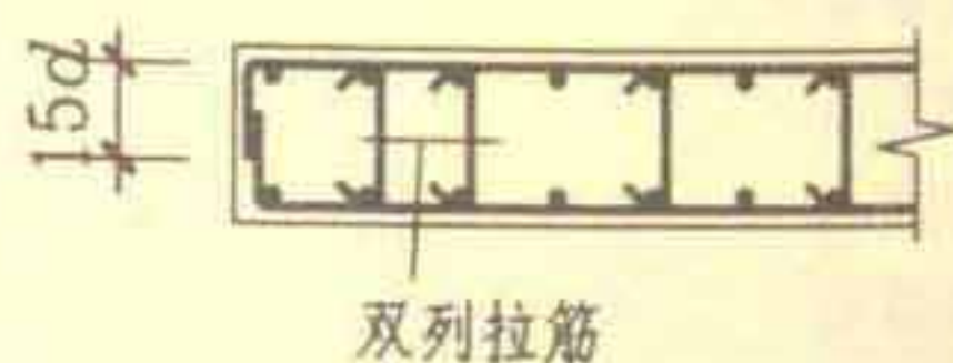
无暗柱时剪力墙 水平钢筋锚固 (二)
