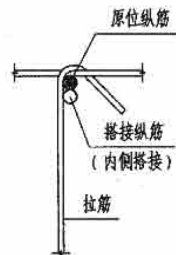
图12 拉筋弯钩位置
