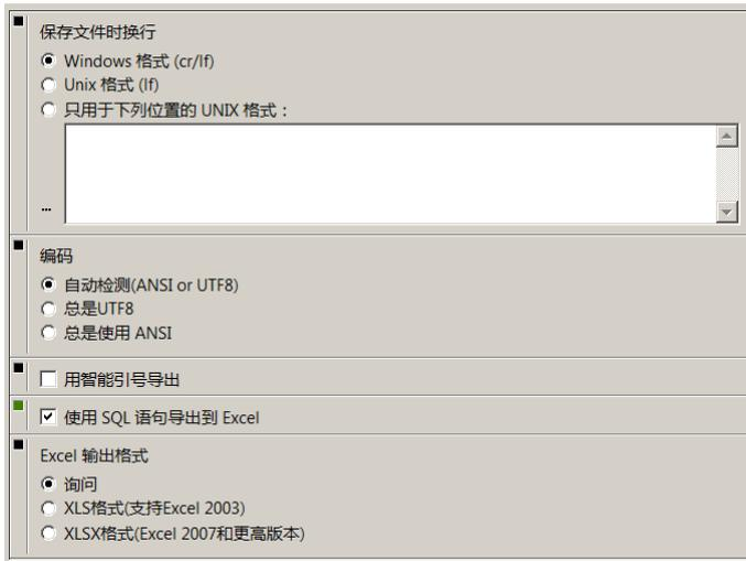
换行选项控制了行在文本文件中怎样被终止。行可以采用 Windows 风格以 CR/LF 字符对来终止，或者采用 Unix/Linux 风格以单一的 LF 字符来终止。你还可以指定文件采用特定存储单元的 Unix 格式和别的 Windows 格式。你可以指定分开的行的多个目录，并且通过按**添加存储单元**按钮(...)来选择一目录。注意不但被保存在这个目录中的文件被格式化为 Unix 风格，而且还包括被保存在这个目录下面的子目录中的所有文件。
