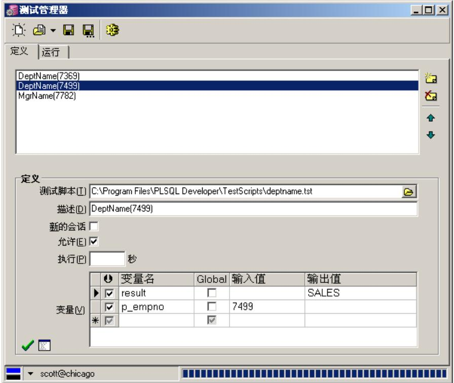
对于这个例子，测试集有三个测试脚本组成。对于被选择的 *DeptName.tst* 脚本，*p\_empno* 变量值将获得输入值 7499，执行后 *result* 变量值一定是 *SALES*。
