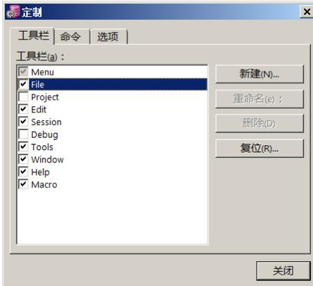
单击 **新建** 按钮创建新工具栏。这将创建一个新工具栏，随后你可以为该工具栏添加按钮。在相同的选项卡页面上，还可以重命名和删除你自己的工具栏。此页上的标准工具栏不能修改。
