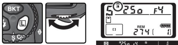
若想解除对快门速度的锁定，请按下 ■ 按钮并旋转主指令拨盘直到锁定图标从显示中消失。
