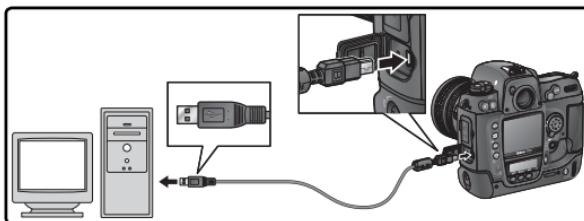
**4** 打开相机。若 **USB** 选择为 **Mass storage**，机背控制面板和取景器上将会显示 **PC**。机顶控制面板的光圈显示中也会出现一个 **PC**，同时 **PC** 模式指示将会闪烁（若选择了 **PTP**，只有在运行 Nikon Capture 4 Camera Control 软件时，相机显示才会改变）。可以按照 PictureProject 参考手册（在 CD 上）所述方法将照片发送到电脑中。
