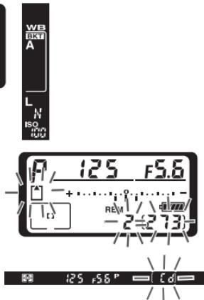
如果在包围序列中的拍摄数量多于曝光保持的图片张数时，一个闪动的
