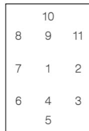
按照右图所示的顺序顺时针旋转副指令拨盘以旋转经过对焦区域，逆时针方向旋转则可以相反的顺序经过对焦区域。当高速剪裁模式处于开启状态时，5和10对焦区域不起作用。
