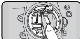
**3** 取下旧的对焦屏。用镊子夹住标签小心操作，避免划伤屏幕。
