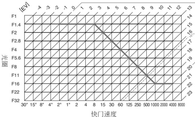
EV 的最大和最小值根据感光度（等同于 ISO）的不同而有所不同；上面的图表假定了一个和 ISO 100 等价的感光度；当使用矩阵测光时，超过  $16\frac{1}{3}$  EV 的值将被减少至  $16\frac{1}{3}$  EV。
