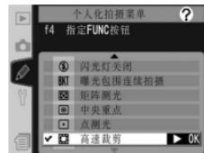
**2** 按 FUNC 按钮并旋转主指令拨盘。当高速剪裁指示器在机顶控制面板中显示并在取景器中闪烁时，高速剪裁模式开启。
