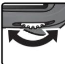
若要立刻使用新的白平衡预设值, 可通过按下 **WB** 按钮并转动副指令拨盘直至机背控制面板 (63) 上显示 **d-0** 的方法来选择预设 **d-0**。而在测量新的白平衡值时, 没有必要选择 **d-0**。
