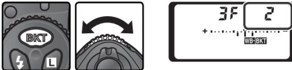
**4** 构筑一幅照片、对焦、拍摄。每次拍摄可建立在包围程序中指定的复制数量，并且每个复制都会有一个不同的白平衡。使用白平衡微调功能（**56**）对白平衡所做的修正可被添加到白平衡调整中。
