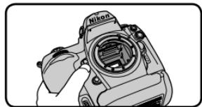
**7** 关闭相机。反光板降下，快门帘幕关闭。安装好镜头或卡口盖，并断开与交流电适配器的连接。
