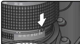
若在安装 CPU 镜头时忽略了此步骤，那么在开启相机时，控制面板和取景器中将会显示一个闪烁的 **FEF** 图示，这时，您必须关闭相机并在最高 (f/- 值) 处锁定光圈之后，才能开始拍摄照片。
