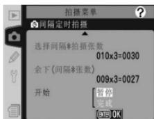
当拍摄被暂停时，开始时间会被重置为 **当前**。同在第二步“间隔定时拍摄”（ 122）中所描述的相同可以选择一个新的开始时间。但是间隔、间隔数和拍摄数不能被改变。如果在拍摄过程中间隔定时拍摄被暂停，则当前间隔下所有的剩余拍摄都将会被取消。
