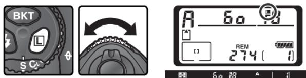
要对光圈解除锁定，请按 ■ 按钮并旋转主指令拨盘直到锁定图标从显示中消失。
