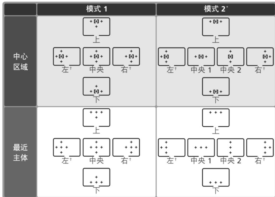
\* 通过以下操作可选择中央对焦区域组：先按一次多重选择器的中央按钮，来激活当前的中央对焦区域组，再按下多重选择器的中央按钮，以在“中央 1”和“中央 2”之间进行切换。当在 **中央按钮**（用户设定 f1）>**拍摄模式** 中选定 **中央自动对焦区域**（默认选项）时，仅可以选用“中央 2”。
