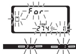
在格式化的过程中，字母 **For** 将出现在帧数显示位置上。当格式化完成时，帧数项上将显示当前设定中可存储的照片数。
