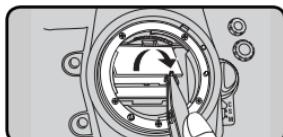
**4** 用镊子夹住要换上的屏幕的标签，把新的对焦屏贴放到屏幕支架上。
