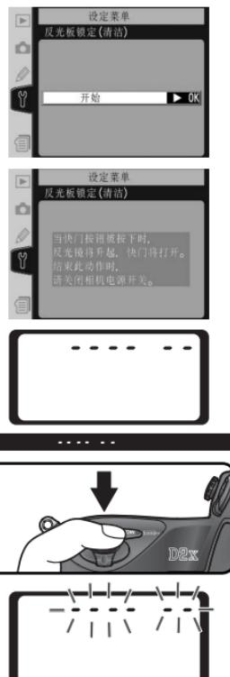
**4** 向右按下多重选择器。在相机显示屏中将出 现如右图所示的信息，并且在控制面板和取 景器中将显示一行破折号。若要不升起反光 板而返回正常操作，请关闭相机。若显示屏 允许自动关闭，反光板锁定也会自动取消。
