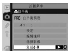
**2** 向右按下多重选择器，将白平衡从 d-0 中复制到所选择的预设中，并返回到缩略图一览表中。若已经为 d-0 创建了注释，该注释将被复制为所选择预设的注释。
