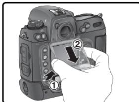
若需要复原显示屏盖时，请将显示屏盖顶部的两个突起部分插入到相机显示屏（①）上的与之匹配的插槽里，然后将屏盖的下方按入直至听到咔哒声为止（②）。
