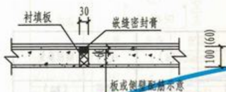
钢筋混凝土内衬底板、侧壁变形缝
