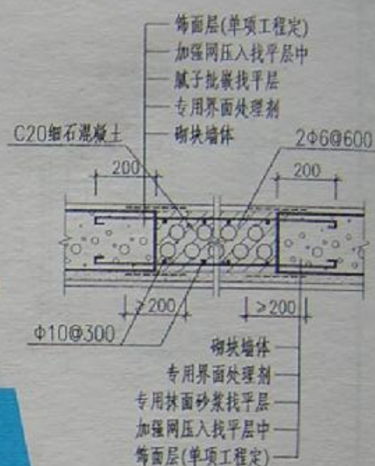
③ 密集暗埋管线墙体加强示意
